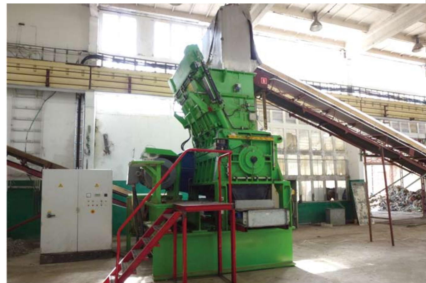
Wysokowydajna rozdrabniarka MeWa UG 1608 MS do produkcji paliwa alternatywnego.
